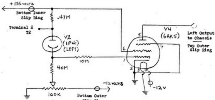
6. CIRCUITS -- F. CHASSIS AMPLIFIER, LEFT EYE
